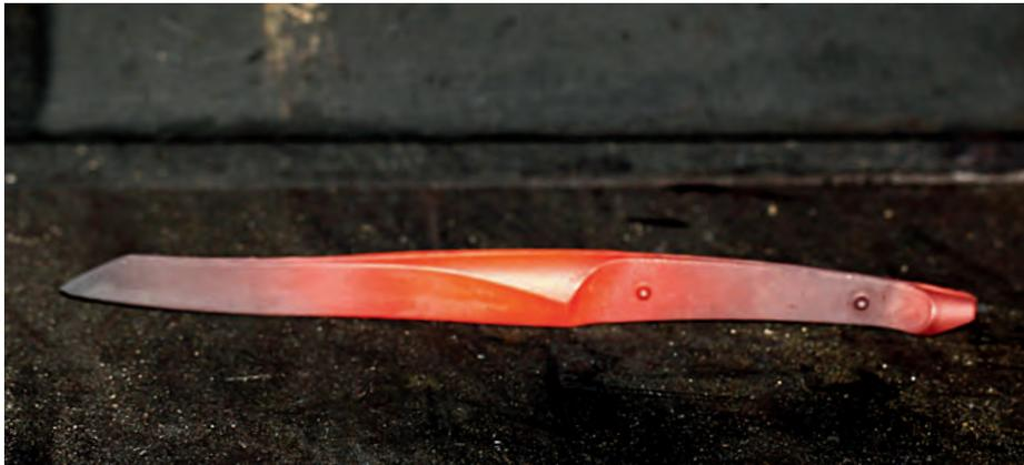
**Rostbeständiger 1.4123-Stahl:** Die Klinsen werden in der Wärmebehandlung auf eine Rockwell-Härte von 58 bis 59 HRC gebracht.
