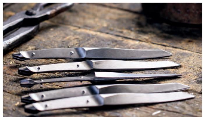
Die fertigen Rohlinge: Man sieht bereits sehr gut die komplexe Form des Integralmessers.
