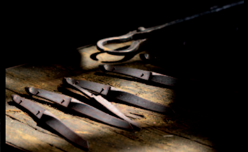
sknife Messer 100 % Swiss Made: aus einem Stück gehärtetem Stahl geschmiedet und bei Messerschmied Hansjörg Kilchenmann vollendet.
