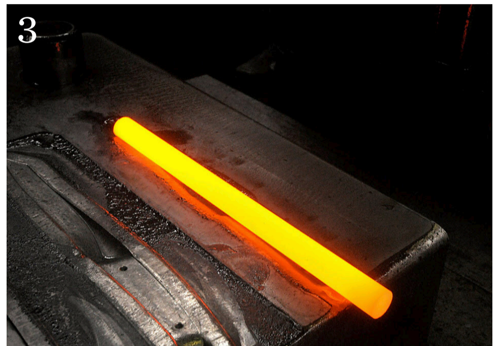
3 Heisses Eisen aus dem Feuer geholt: Links die Form für das Steakmesser.
