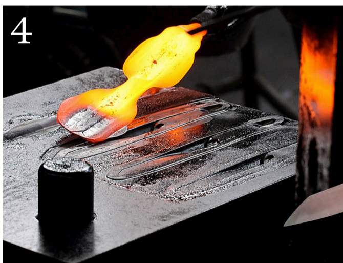
4 Plattgedrückt: Die Form des Messers wird langsam ersichtlich.
