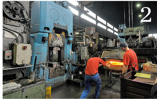
2 Der Ofen ist angeheizt und die einzelnen Stangen werden ins Feuer gelegt. Erst wenn sie glühen, sind sie bereit zur Formgebung.
