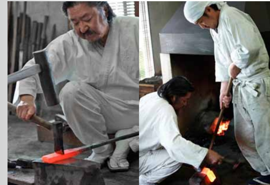
Meister Fujiwara Kanefusa faltet und schmiedet einen Damastrohling.
